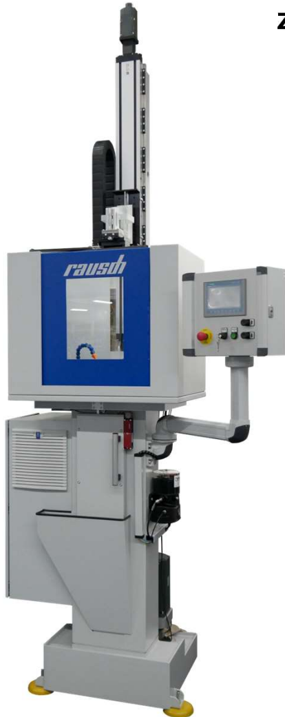
Senkrecht Räummaschine Baujahr 2023
